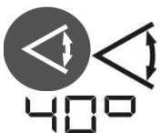
Durch Drücken der Scan-Taste gelangt man in den Scan-Modus, mit der kleinsten Einstellung von 10°. Durch weiteres Drücken der Taste können 5 verschiedene Größen einer Laserlinie erzeugt werden (10°, 20°, 40°, 60°, 80°); diese werden im Display angezeigt.
