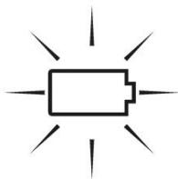
Wenn die 3 Balken in der Anzeige leer sind und der äußere Rahmen blinkt, ist die Kapazität erschöpft und der Akku muss geladen werden.
