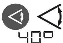
Un appui sur la touche Scan permet d'accéder au mode Scan au réglage le plus petit de  $10^\circ$ . Des appuis supplémentaires sur la touche permettent de générer 5 dimensions différentes de ligne laser ( $10^\circ, 20^\circ, 40^\circ, 60^\circ, 80^\circ$ ) ; elles sont affichées à l'écran.
