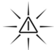
En cas de modifications plus importantes de la position de montage (par ex. après le déplacement involontaire du trépied), une fonction TILT permet de garantir que l'appareil s'éteint et indique le déplacement par un clignotement rapide du rayon laser et du triangle d'avertissement.
