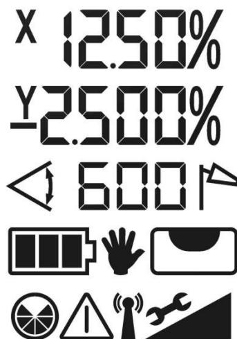
Die FB-V durch Drücken einer beliebigen Taste einschalten. Die Fernbedienung sucht sich automatisch einen passenden Kanal, um auszuschließen, dass es zu Störungen mit anderen Geräten kommt. Im Display finden sich die gleichen Angaben wieder wie auf dem Display des dazugehörigen Lasers. Ist dies nicht der Fall und wird stattdessen ein Antennensymbol angezeigt, kann dies folgende Gründe haben:
