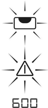
L'affichage du niveau clignote dans l'écran éclairé. Une inclinaison de la tête du trépied supérieure à 5° est signalée après un court instant par un clignotement rapide du rayon laser et du symbole d'alarme.
