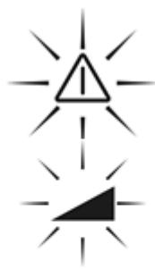
Lorsque la position de l'appareil change en raison des influences extérieures, ceci est enregistré par le contrôle Autoslope et le réajustage démarre automatiquement. En cas de problèmes d'alignement plus importants, la rotation est interrompue, le rayon laser, le symbole d'inclinaison et l'avertissement clignotent rapidement à l'écran.
